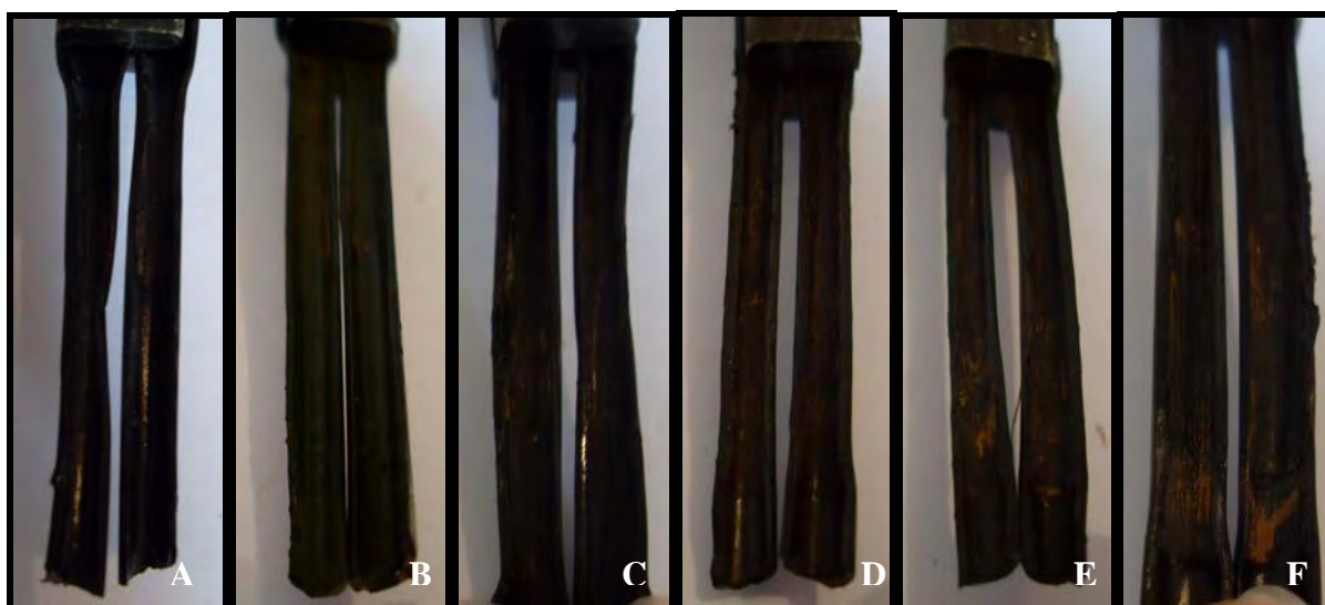
Apêndice 4: Visualização do primeiro, décimo e vigésimo “spagueti” dos emissores Netafim (A-C) e Amanco (D-F) no teor de 0,5 \text{ mg.L}^{-1} \text{ Fe} . Botucatu, SP, FCA- UNESP, 2010.
