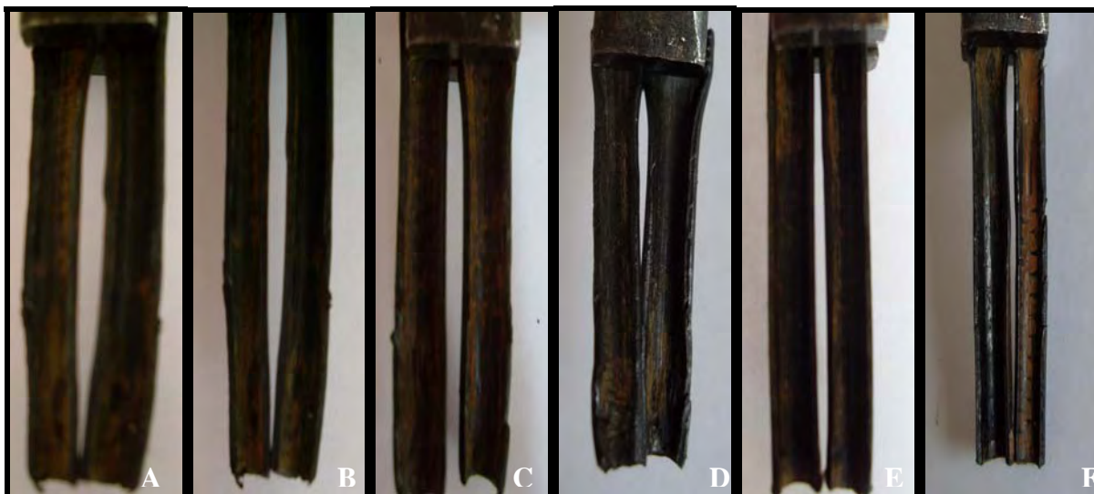
Apêndice 7: Visualização do primeiro, décimo e vigésimo “spaguetti” dos emissores Netafim (A-C) e Amanco (D-F) no teor de 1,5 \text{ mg.L}^{-1} \text{ Fe} . Botucatu, SP, FCA- UNESP, 2010.
