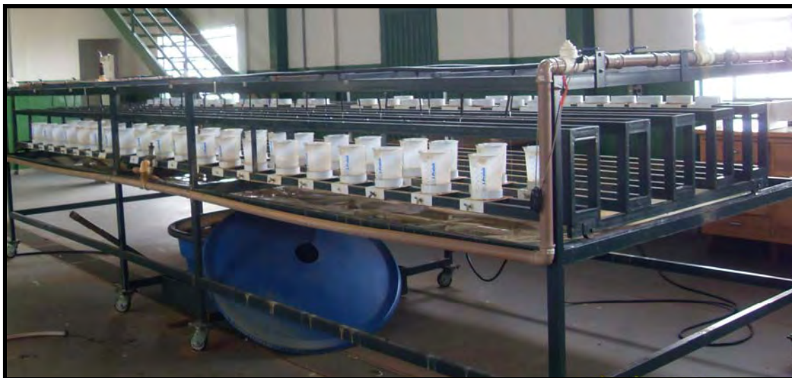
Figura 10: Vista geral da instalação da fase II na bancada de ensaios para tubos gotejadores. Botucatu, SP, FCA-UNESP, 2010.
