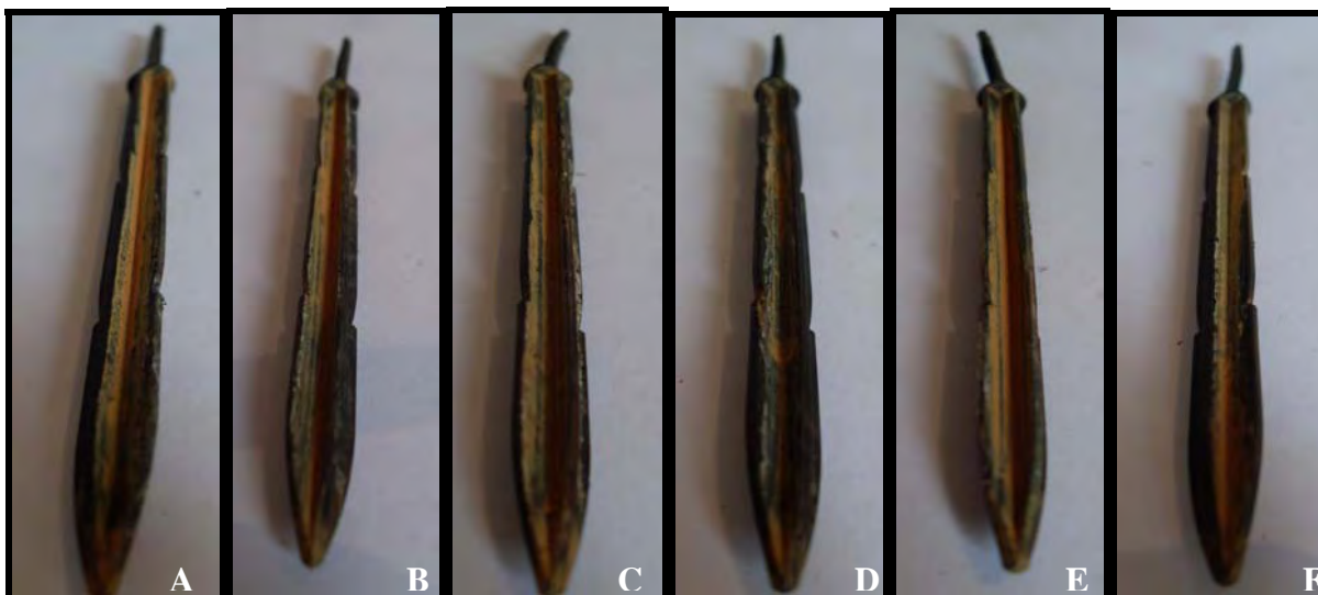
Apêndice 5: Visualização da primeira, décima e vigésima “flecha” dos emissores Netafim (A-C) e Amanco (D-F) no teor de 0,5 \text{ mg.L}^{-1} \text{ Fe} . Botucatu, SP, FCA- UNESP, 2010.
