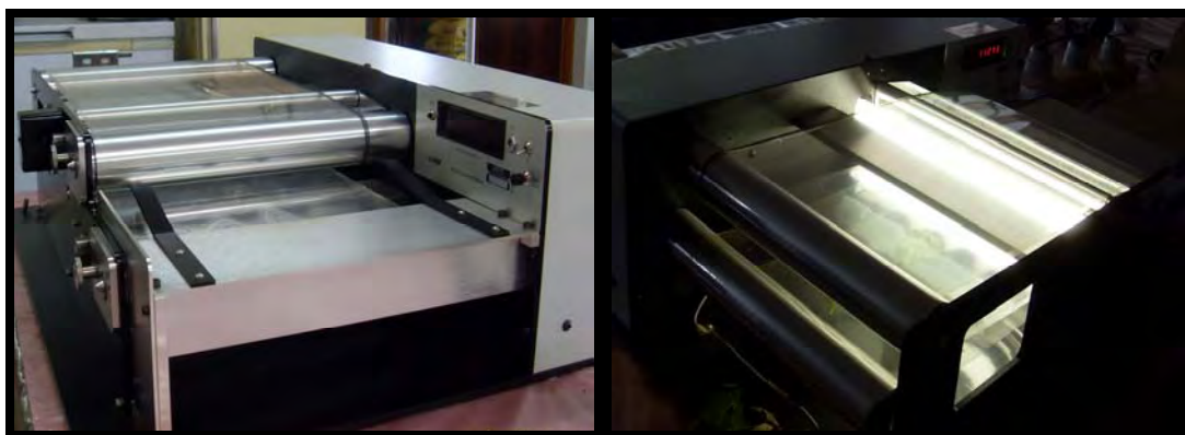
Figura 9: Medidor de área foliar, modelo Li 3100, da marca Licor. Botucatu, SP, FCA-UNESP, 2010.
