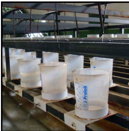
Figura 12: Forma de avaliação do desempenho dos gotejadores modelo Amanco e Netafim. Botucatu, SP, FCA-UNESP, 2010.
