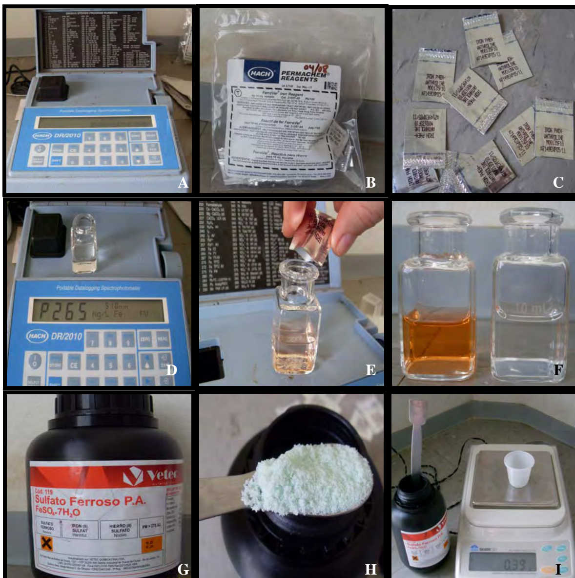
Apêndice 2: Sequência da análise do teor de ferro na água utilizada na Fase 1 e na fase 2 do experimento. Espectrofotômetro (A); Reagente Cat. Nr. 21057.69: FerroVer Iron Reagent Powder Pillow (B-C); Comprimento de onda a 510 nm, com display mg/L Fe, e cubeta de 10 mL (D); Adição do reagente FerroVer (E); Água ferrosa na cubeta de cor alaranjada (F). Sulfato ferroso ( \text{FeSO}_4 \cdot 7\text{H}_2\text{O} comercial) (G); Coloração do sulfato ferroso (H), Método de pesagem (I). Botucatu, SP, FCA-UNESP, 2010.
