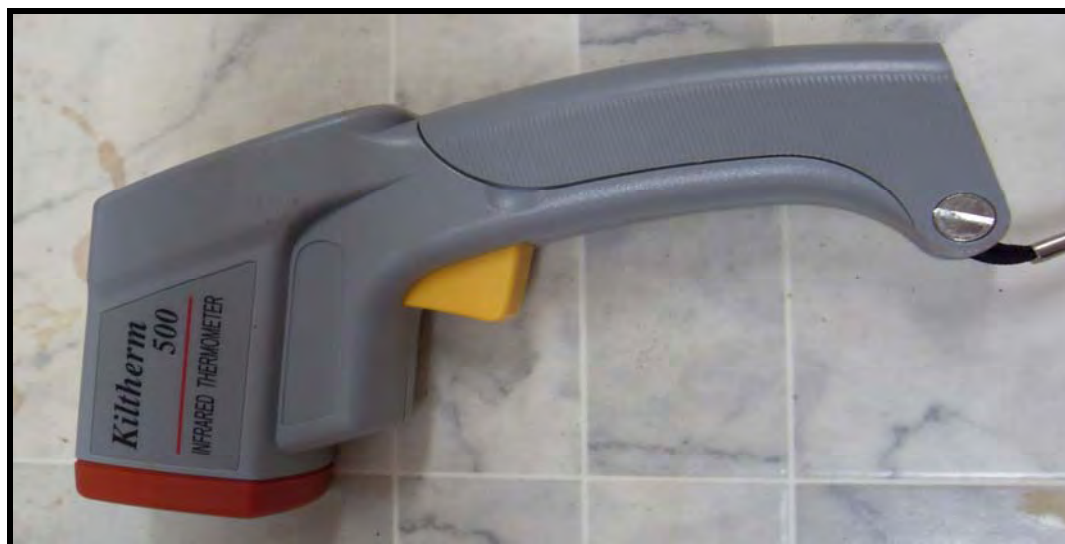
Apêndice 3: Termômetro digital infra-vermelho, marca Kiltherm 500. Botucatu, SP, FCA-UNESP, 2010.
