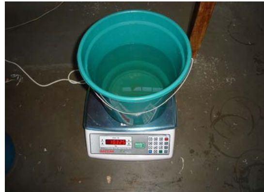
Figura 14. Pesagem dos baldes através de uma balança eletrônica.
