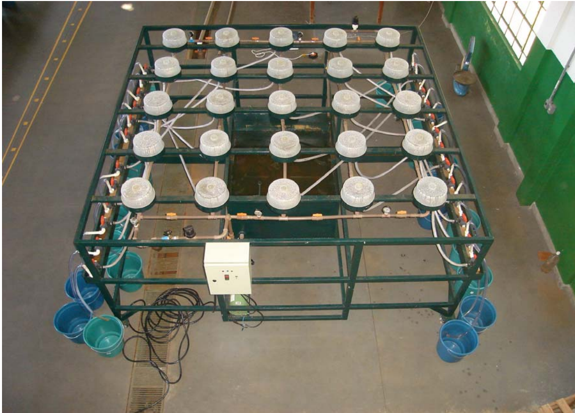
Figura 8. Estrutura da bancada de testes para microaspersor.
