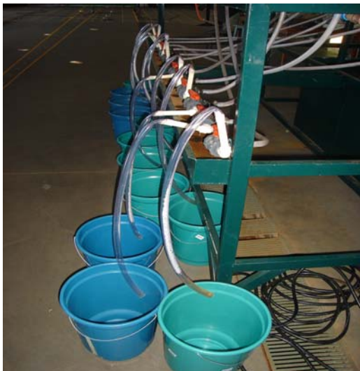
Figura 15. Coleta da vazão dos microaspersores.
