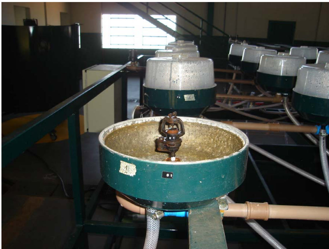
Figura 12. Detalhe do microaspersor posicionado dentro da campânula.
