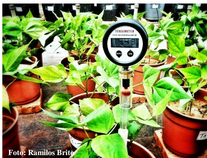
Figura 6 - Aferição do teor de umidade do solo com o auxílio de um tensímetro digital nos solos de textura arenosa, média e argilosa na casa de vegetação do Departamento de Solos e Recursos Ambientais - UNESP/FCA.
