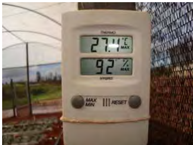
Figura 3. Coleta dos dados de temperatura e de umidade do ar com termo higrômetro digital.
