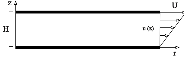
Figura 2.1: Representação esquemática do escoamento de Couette entre duas placas paralelas.
