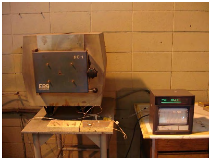
FIGURA 3.4 - Arranjo experimental utilizado durante os tratamentos térmicos.
