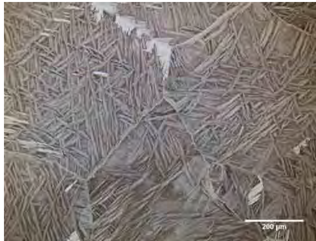
Figura 7.6. Imagem da liga Ti-6Al-4V, tratada termicamente, evidenciando a estrutura de Widmantätten dimensão 1600x1200 pixels.
