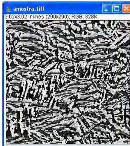
Figura 4.12. Imagem de saída após a correlação com imagem referencia 10x10 pixels em uma matriz de busca 300x300 pixels.
