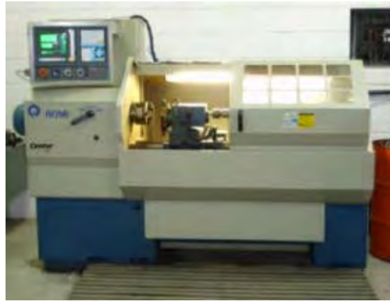
Figura 3.4 - Máquina ferramenta, torno CNC Romi CENTUR 30S
