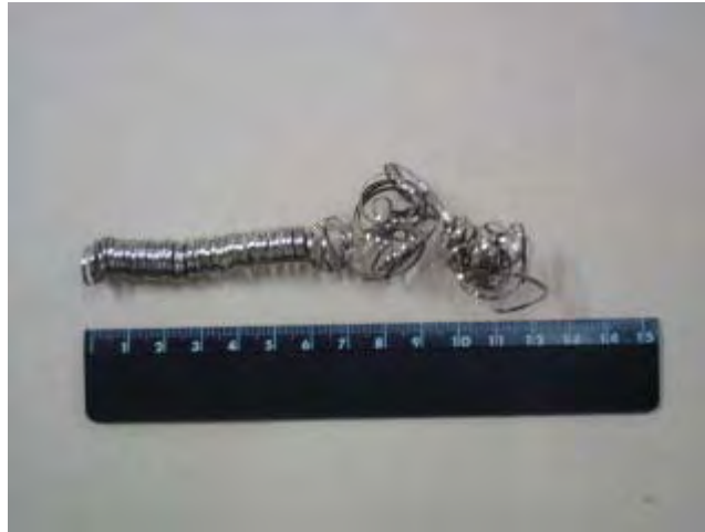
Figura 4.24 – Cavacos obtidos para a v_c = 90 m/min, a_p = 0,8 mm e f = 0,15 mm/volta.
