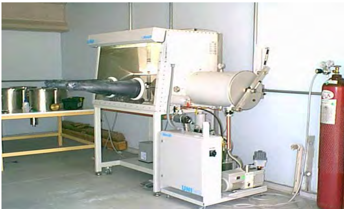
Figura 23 – Fotografia. Vista geral da câmara de gás inerte (glove box) utilizada para a manipulação dos materiais.
