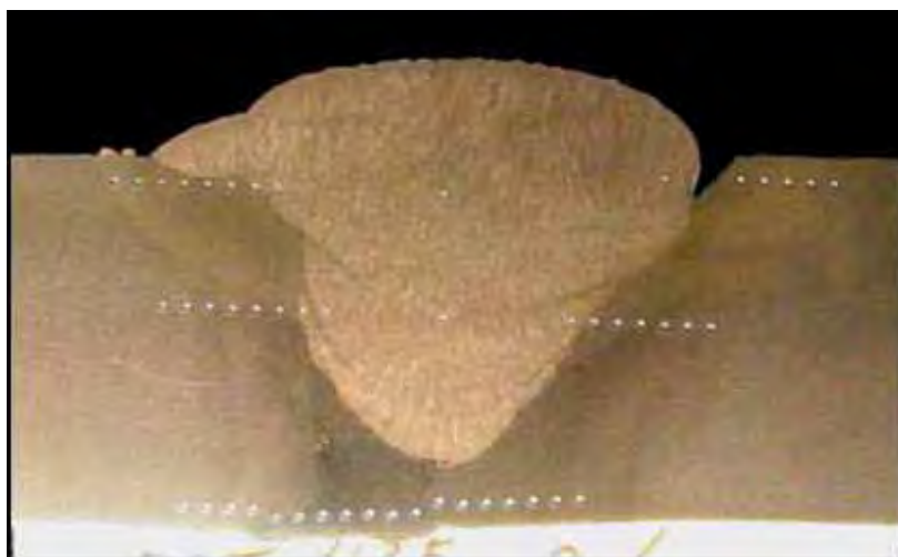
Figura 23 – Formato de uma poça de fusão elíptica para o processo de eletrodo revestido (SANTOS, 2004)
