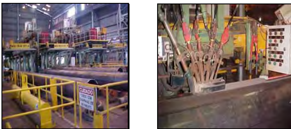
Figura 18 – Equipamento de Soldagem por arco submerso (AS) externo utilizando-se quatro arames (Gentileza Tenaris Confab)
