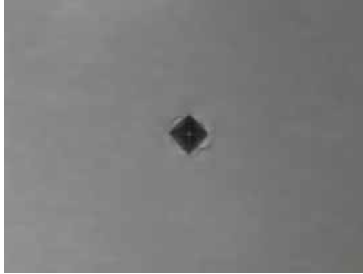
Figura 4.2.2 Fotomicrografia da endentação do ensaio de dureza Vickers (HV) na temperatura de 25°C do aço Complex Phase .
