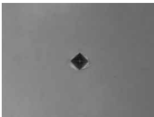
Figura 4.2.6 Fotomicrografia da endentação do ensaio de dureza Vickers (HV) na temperatura de 180°C do aço Complex Phase .
