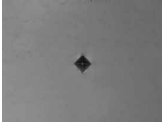
Figura 4.2.4 Fotomicrografia da endentação do ensaio de dureza Vickers (HV) na temperatura de 125°C do aço Complex Phase .
