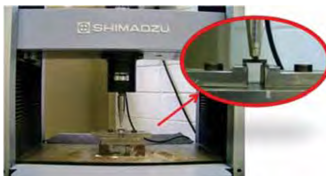
Figura 5.14 – Máquina e suporte de três apoios usado no ensaio de cisalhamento Short Beam .
