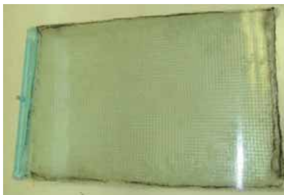
Figura 6.7 – Laminado em fibra de vidro processado em ensaio preliminar do sistema RTM.
