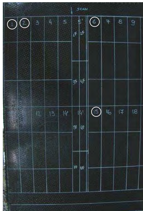
Figura 6.39 – Locais de retirada dos corpos de prova do laminado 1 – 5HS
