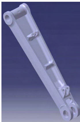
Figura 1.1 – Haste em liga de alumínio
