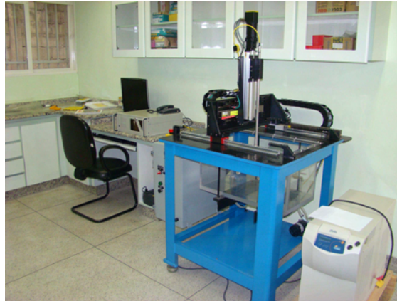
Figura 5.8 – Aparelho de ultrassom C-scan por imersão em água (Processo FAPESP 02121-6)
