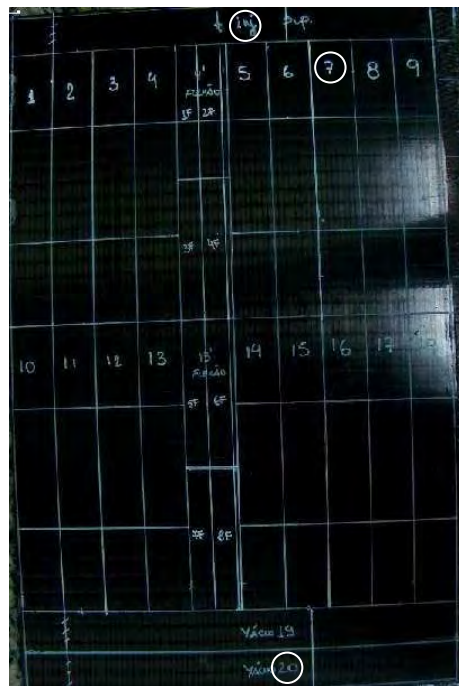
Figura 6.38 – Locais de retirada dos corpos de prova do laminado 6
