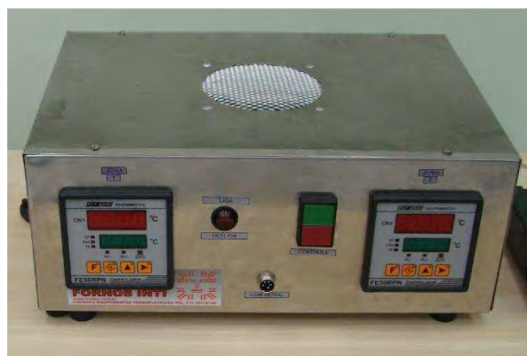
Figura 5.2 – Controlador do sistema de aquecimento do molde
