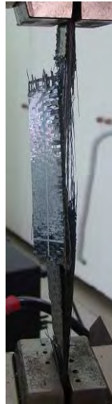
Figura 6.55 – Fratura em fadiga do cdp 3-5HS à 75%
