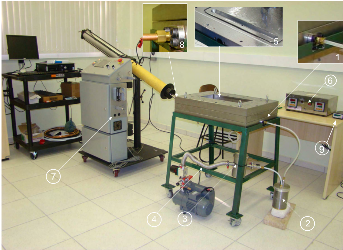
Figura 5.3 – Montagem do processo RTM
