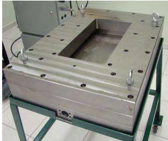
Figura 5.1 – Molde usinado em aço 1045
