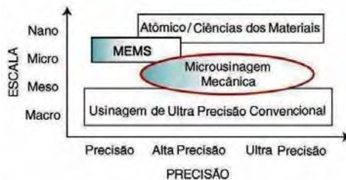
Figura 1 - Grandezas dimensionais para microusinagem mecânica.
