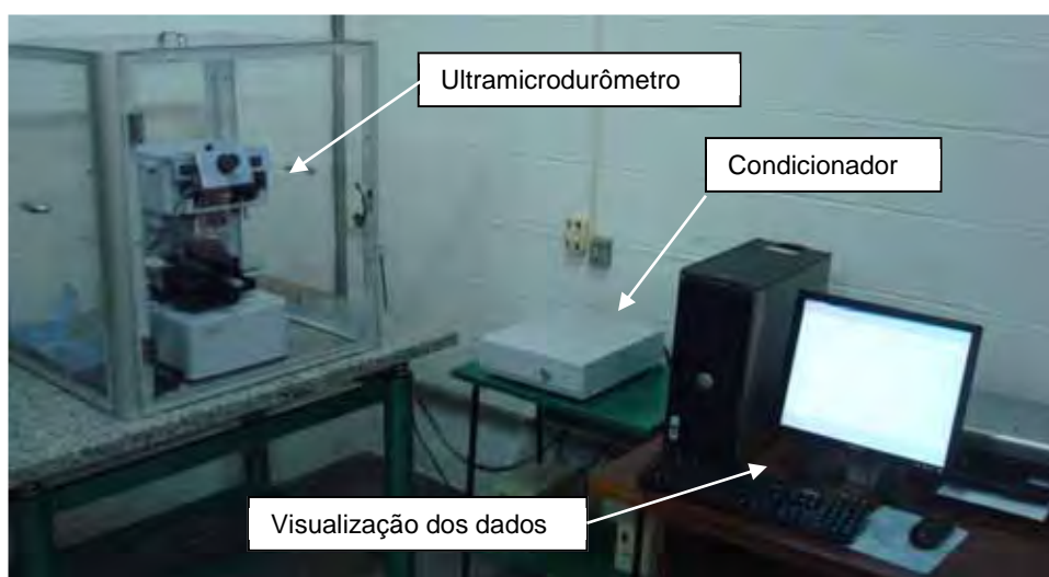
Figura 18 - Sistema de aquisição de dados de microdureza.
