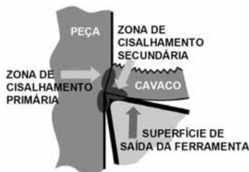
Figura 46 - Zonas de cisalhamento para a estimativa da temperatura na interface cavaco-ferramenta.
