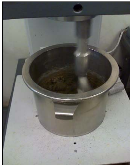
Figura 4.14: MCAD sendo ensaiado no reômetro de concreto.
