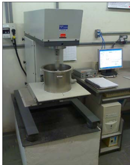
Figura 4. 13: Reômetro de concreto utilizado no ensaio com o MCAD (Fonte: DEMa – UFSCar).
