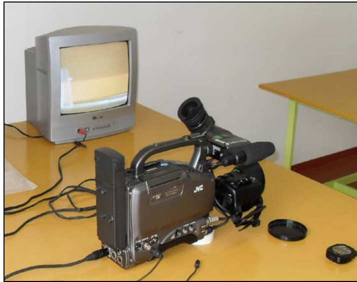
Figura 5. 21: Equipamentos utilizados para visualização do abatimento do concreto.
