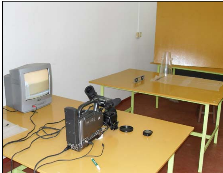
Figura 5. 22: Posição da filmadora em relação ao cone de acrílico.
