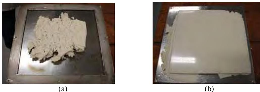
**Figura 13** – PVC reciclado (a) antes da prensagem e (b) em placas moldadas.
