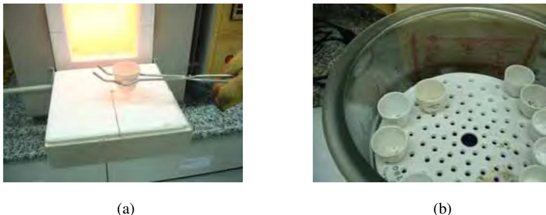
**Figura 11** – (a) Colocação de cadinho na mufla a 1.050°C e (b) resfriamento no dessecador.
