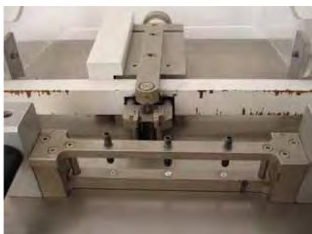
**Figura 16** – Fresa para confecção de corpos de prova com gabarito para ensaios de tração.
