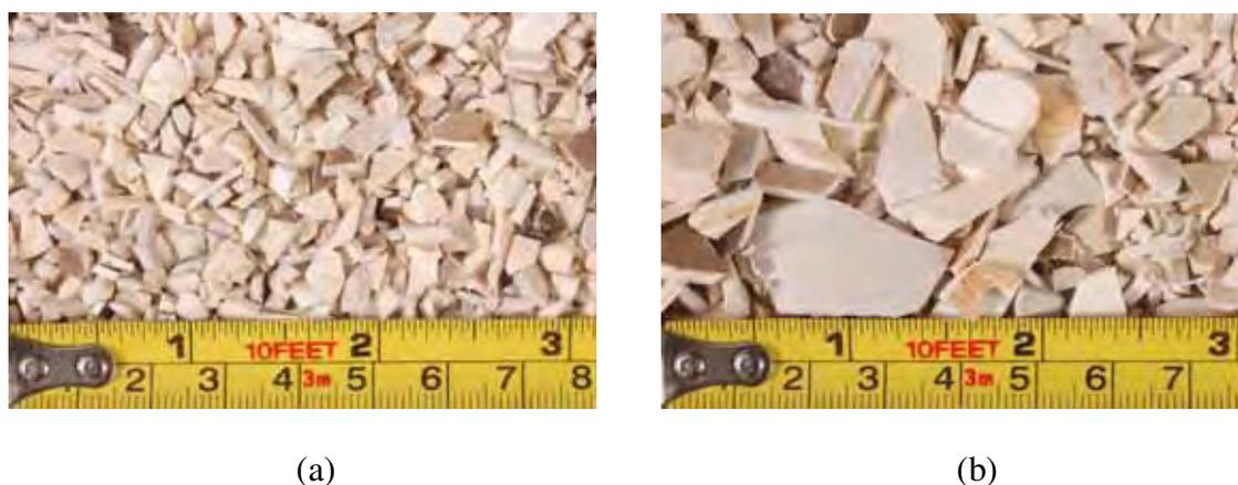
**Figura 8** – PVC moído na faixa granulométrica de (a) 8 mm e (b) 12,7 mm.
