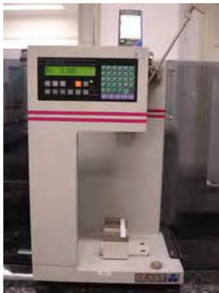
**Figura 18** – Máquina de Impacto Pendular utilizada nos ensaios de Resistência ao Impacto.
