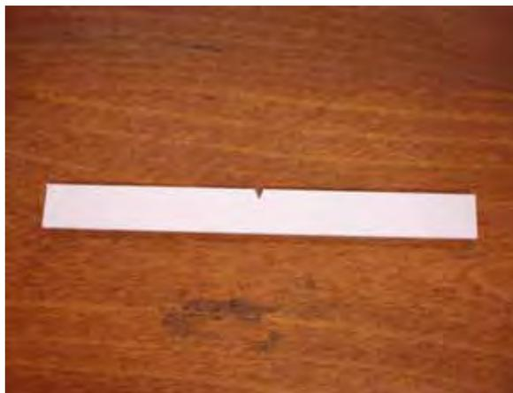
**Figura 19** – Corpo de prova entalhado utilizado no ensaio de Resistência ao Impacto Charpy.
