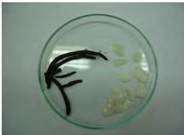
**Figura 15** – Pedacos de PVC (pretos, à esquerda) e PET (brancos à direita) após o ensaio em forno-mufla a 240°C por 15 minutos.
