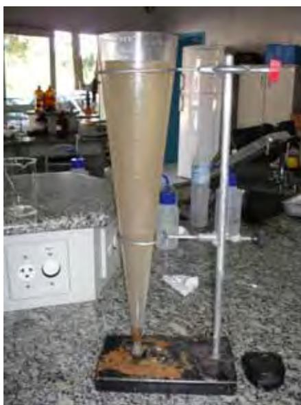
**Figura 9** - Cone de Imhoff para determinação do teor de sólidos sedimentáveis.
