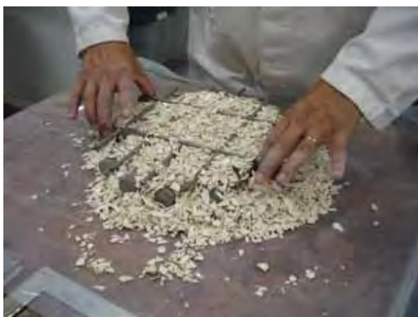
**Figura 12** – Separação de resíduos metálicos com barra magnética.
