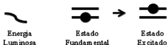
Figura 4.3 – Representação do processo de espectrografia por absorção atômica (SILVA JÚNIOR et al, 2006).
