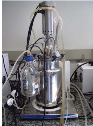
Figura 9 - Fermentador 7L TECBIO - TECNAL, Piracicaba, SP (Fonte: Thaís Shinya).
