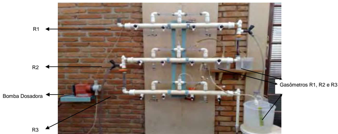
FIGURA 3. Unidade experimental composta de reator anaeróbio horizontal com manta de lodo (RAHML - R1) e dois reatores anaeróbios horizontais de leito fixo (RAHLF - R2 e R3), Bomba dosadora. Tanque de armazenamento. Selos hidráulicos e gasômetros.
