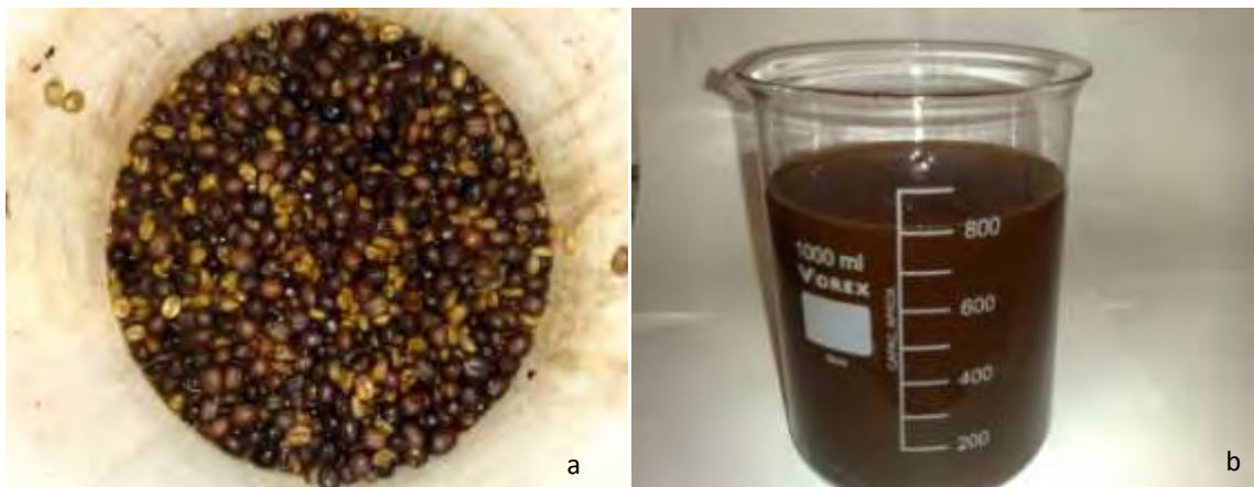
FIGURA 5. Café em coco imerso em água na proporção de 3 litros de água para 1 litro de café por um período de 24 horas (a), água residuária proveniente do descascamento do café em coco por atritamento manual (b).
