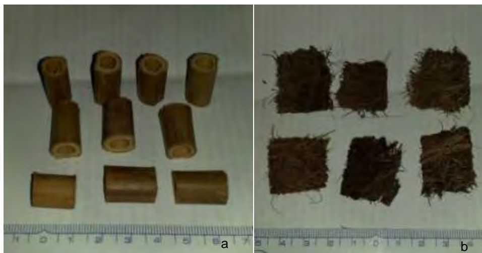
FIGURA 4. Anéis de bambu (a) e cubos de fibra de coco (b), materiais usados como meio suporte no preenchimento de 50% do volume total dos reatores R2 e R3, respectivamente.
