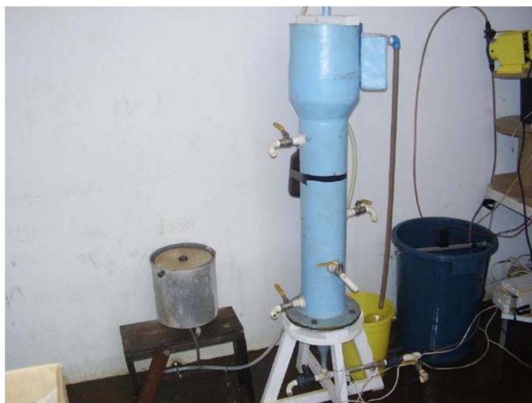
Figura 3.4. Reator 1 – reator anaeróbio de fluxo ascendente com manta de lodo (UASB) de 18,4 L, em escala de bancada.
