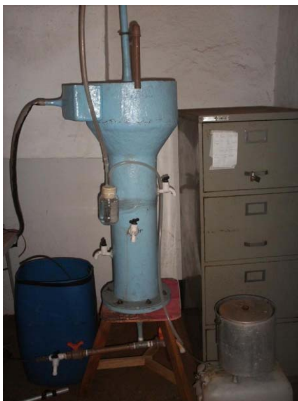
Figura 3.5. Reator 2 – reator anaeróbio de fluxo ascendente com manta de lodo (UASB) de 38 L, em escala de bancada.
