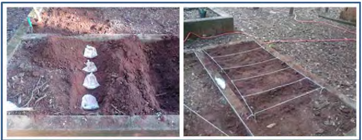
Figura 16 - Solos sendo enterrados para análise posterior de toxicidade.
