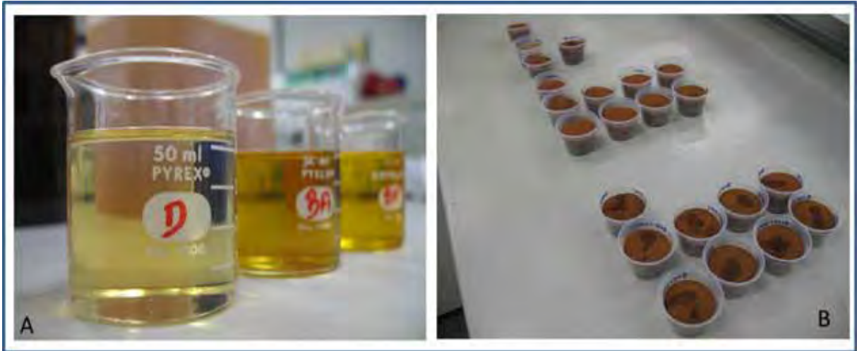
Figura 05 - Preparo das misturas do substrato com os contaminantes. A: contaminantes (Diesel, BA e BV), B: preparo das misturas a serem utilizadas nos respirômetros.
