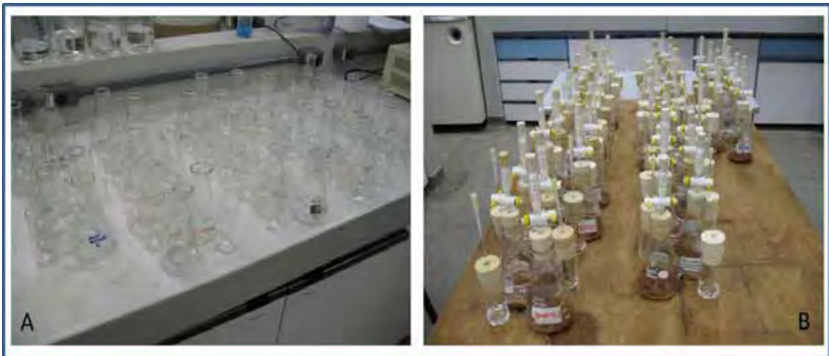
Figura 06 - Preparo concluído e sistemas pronto para incubação. A: vidraria limpa e pronta para uso, B: respirômetros prontos para incubação.
