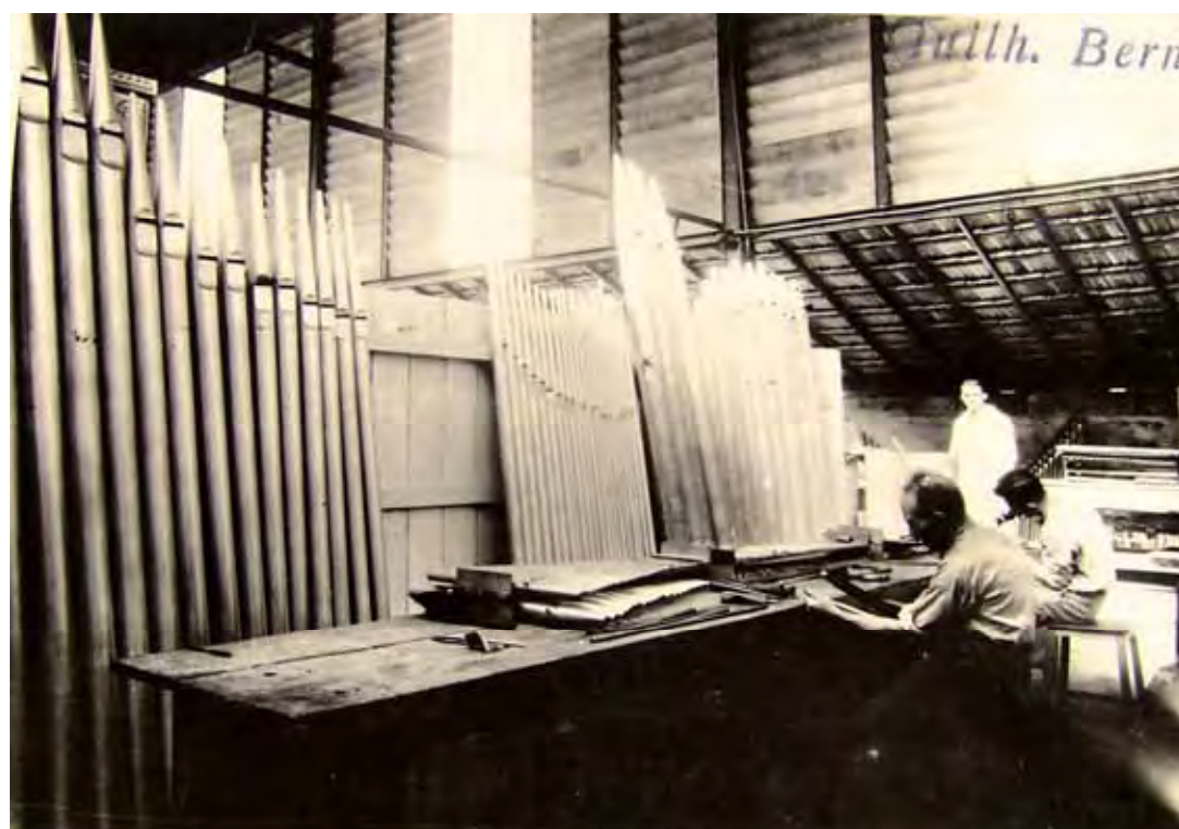
Figura 48: Interior da fábrica – acabamento dos tubos de metal
