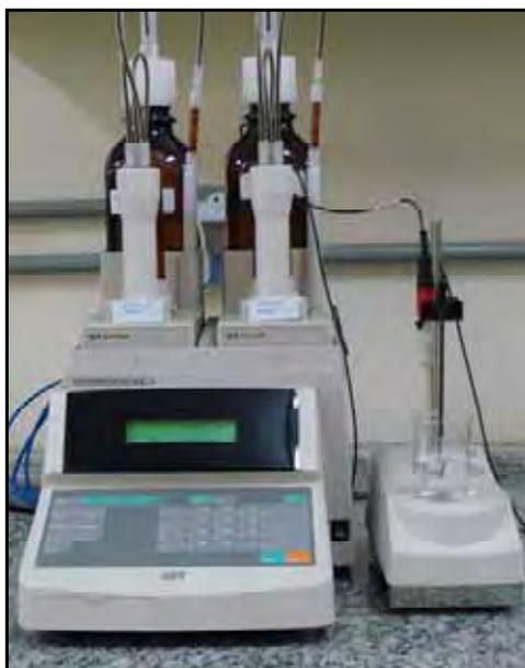
FIGURA 1B - Titulador potenciométrico automático.
