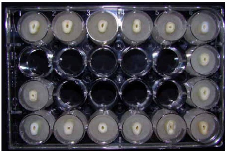
FIGURA 3A - Espécimes fixados com resina acrílica em microplaca.
