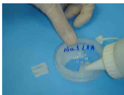
Figura 8: Vedação do orifício com vaselina
