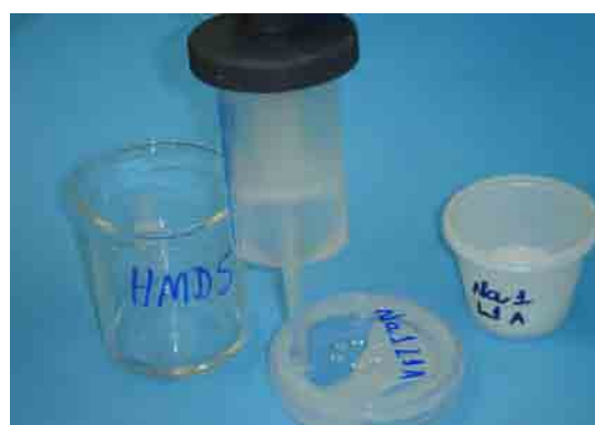
Figura 7: Colocação de HMDS pelo orifício da tampa
