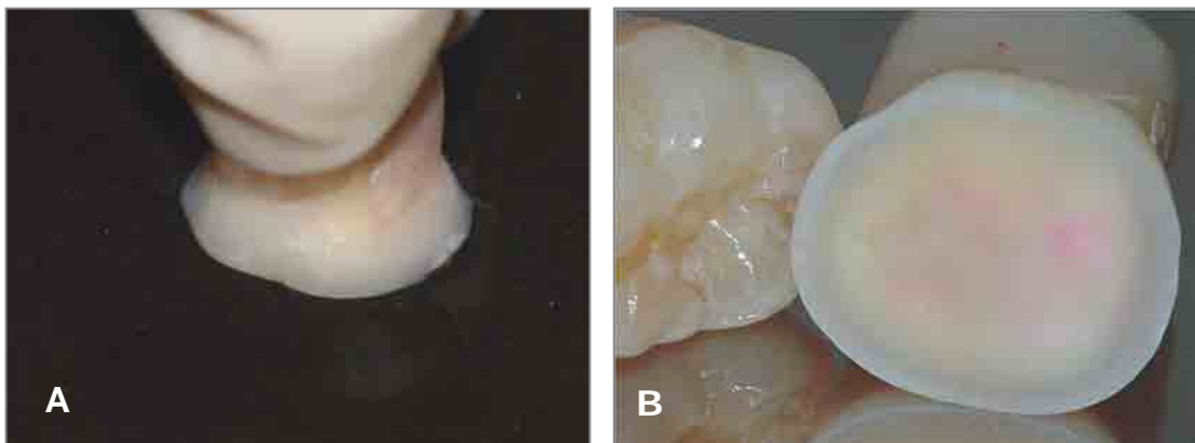
FIGURA 3- A) Desgaste da superfície oclusal do dente em politriz; B) aspecto da superfície plana em dentina na qual pode ser observada, devido à pequena espessura da dentina remanescente, a pigmentação rósea da resina utilizada para o preenchimento da câmara coronária.
