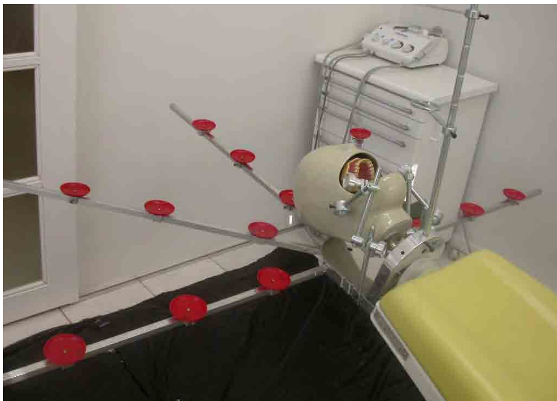
Figura 1 – Estrutura do dispositivo metálico acoplado à cadeira odontológica com as hastes e os suportes plásticos delimitando as distâncias de 20, 40 e 60 cm ao centro da cavidade bucal do manequim.
