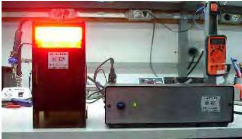
FIGURA 1 - Protótipo do dispositivo de irradiação LED Table, desenvolvido em associação com o Grupo de Óptica (GO) do CePOF/IFSC/USP.
