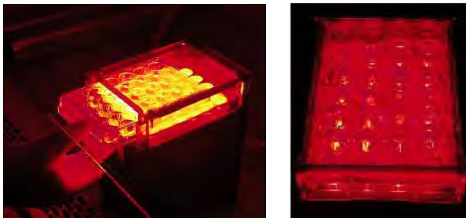
FIGURA 4 - Placa de acrílico de 24 compartimentos adaptada a LED Table.
