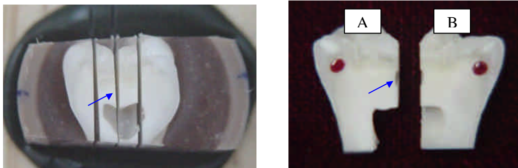
FIGURA 7: Obtenção das amostras A e B de cada espécime, marcadas com esmalte de unha Colorama ® no lado a ser metalizado.
