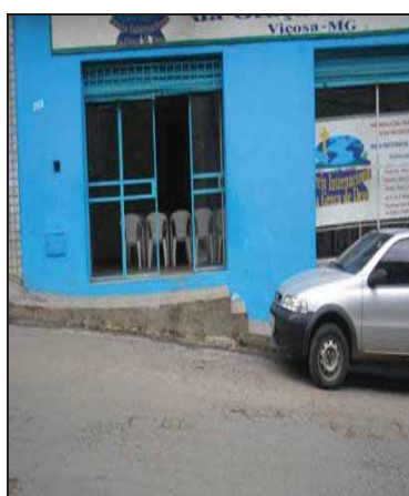
Figura 40 - Degraus na calçada e desnível excessivo entre rua e passeio, na Rua Tenente Kümmel.
