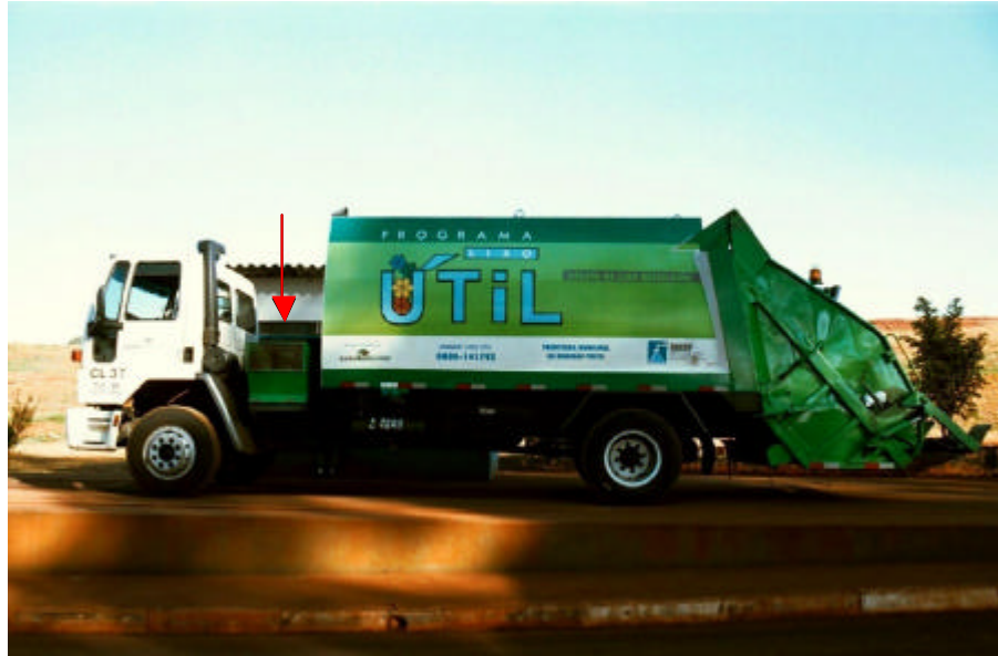
Figura 11 - Caminhão com carroceria do tipo compactadora utilizado na coleta seletiva do município de Ribeirão Preto – Programa Lixo Útil. A seta em vermelho indica o local destinado para vidros e metais. (Foto do Autor).
