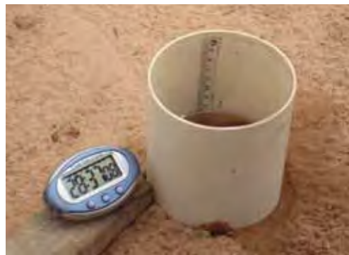
Fig. 06 – Medição da infiltração com o uso do infiltrômetro de Hills (1970, apud GUERRA, 2002).
