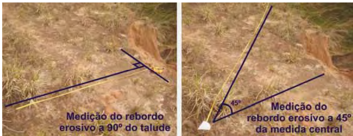
Fig. 14a e 14b - Medição perpendicular ao rebordo erosivo e medição a 45° com o uso do gabarito, respectivamente.
