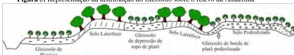
Figura 5: Representação da distribuição do Gleissolo sobre o relevo da Amazônia
