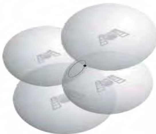
Figura 11: Determinação de um ponto a partir do encontro dos dados de quatro satélites. Fonte: HASENACK 1997.
