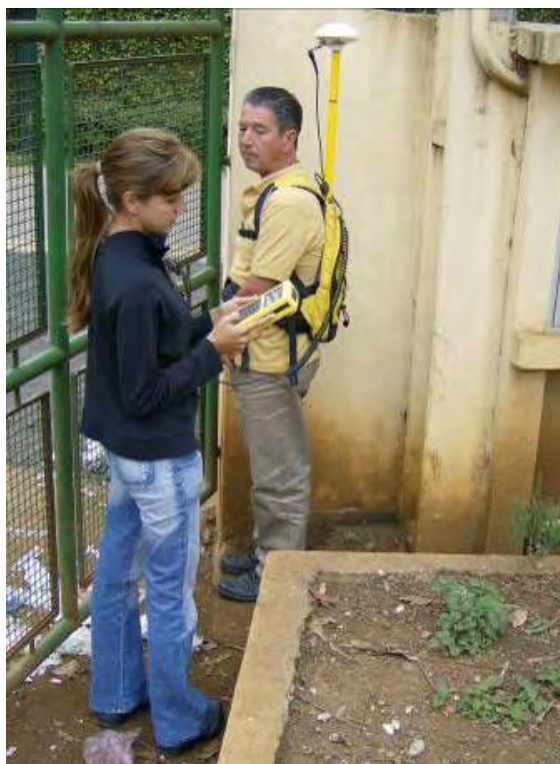
Figura 8 – Instrumento GPS (receptor na mochila do técnico) e o coletor de dados nas mãos da operadora – limites da Aldeia TEKOA Pyau. Fonte: CABRAL, M. C., 2006.
