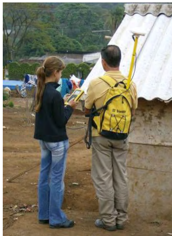
Figura 9 – Receptor GPS (mochila do assistente) e coletor de dados (operadora) registrando a extremidade de uma residência – Aldeia TEKOA PYAU. Fonte: CABRAL, M. C., 2006.
