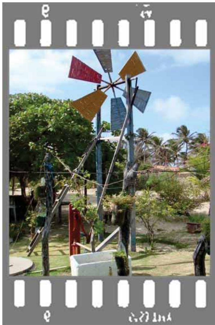
Figura 37. Captação de água do subsolo por meio de catavento. Fonte: Araripe (2011).
