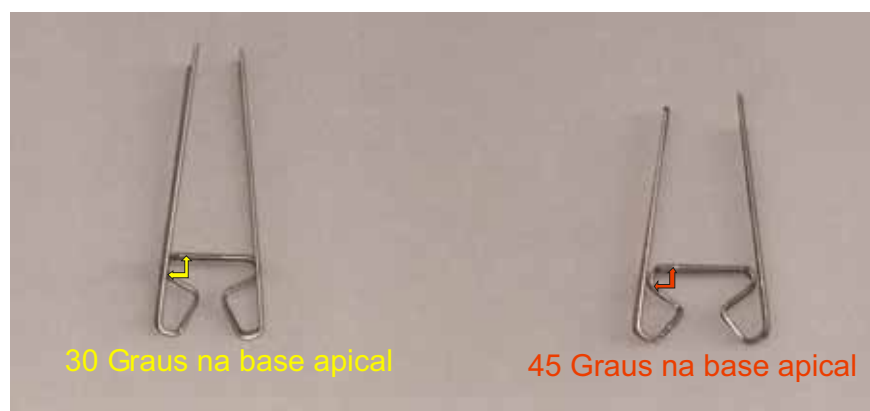
FIGURA 8. Template para padronizar a confecção das molas T padrão Marcotte (45 graus) e Souza (30 graus).
