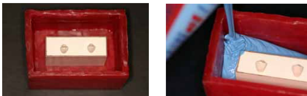
FIGURA 3. Posicionou-se a matriz dentro da caixa de cera e evertu-se silicona para obtenção do negativo.
