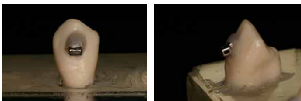
FIGURA 7. Modelo fotoelástico com os tubos cruzados posicionados.
