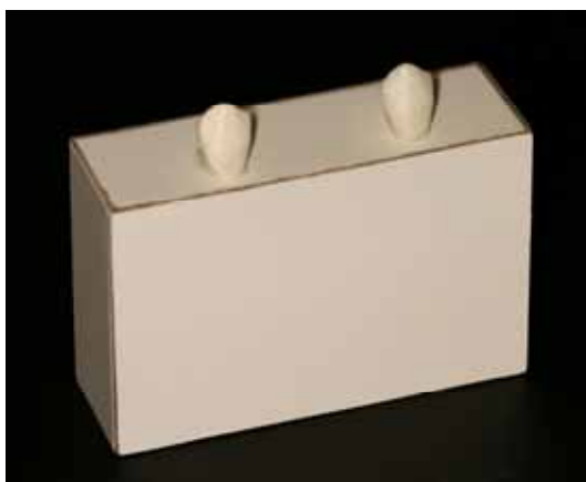
Figura 1. Matriz confeccionada de fórmica para servir de duplicador. Observamos o posicionamento das coroas dos caninos que servirão de parâmetro para o modelo fotoelástico.
