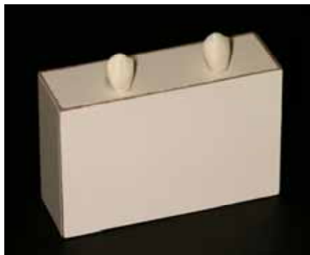
FIGURA 2. Modelo-mestre confeccionado de fórmica para servir de duplicador. Observar o posicionamento das coroas dos caninos que servirão de parâmetro para o modelo fotoelástico.
