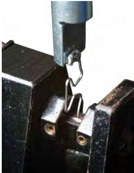
FIGURA 10 - Mola "T" posicionada simetricamente no espaço de 23 mm.
