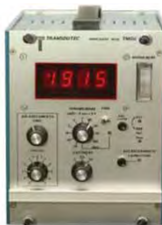
FIGURA 9 - Indicador digital para extensometria utilizado para medição dos momentos.
