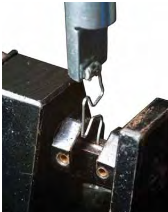
FIGURA 11 - Mola "T" posicionada simetricamente no espaço de 23 mm.
