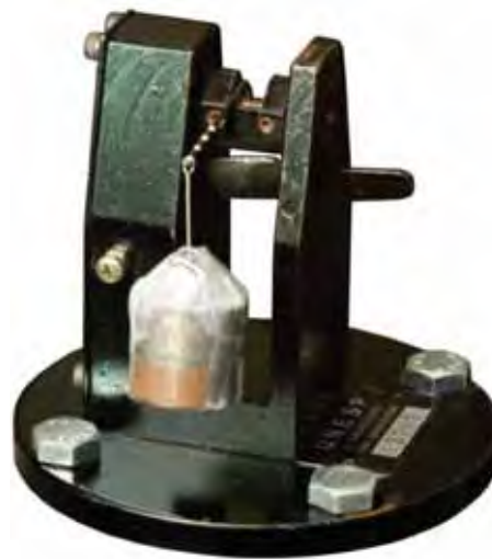
FIGURA 8 - Transdutor de momentos em calibração para realização dos ensaios.
