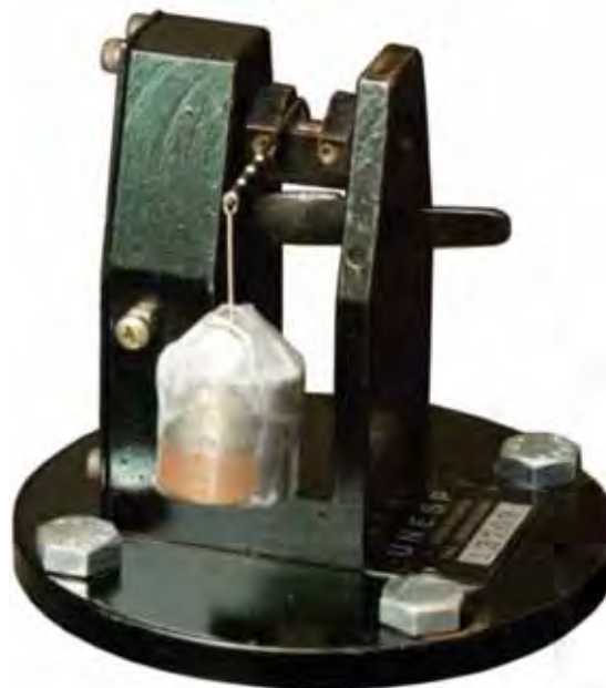
FIGURA 9 - Transdutor de momentos em calibração para realização dos ensaios.
