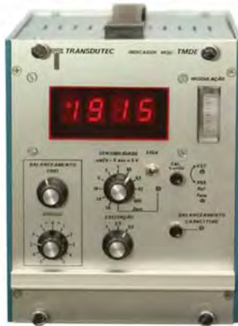
FIGURA 10 - Indicador digital para extensometria utilizado para medição dos momentos.
