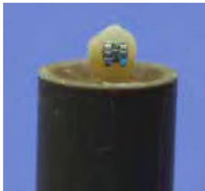
FIGURA 7 – Corpo de prova após colagem do bráquete.
