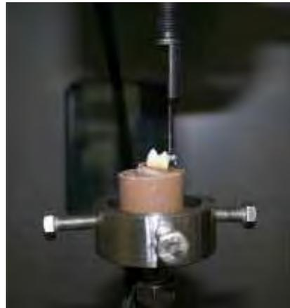
FIGURA 13 – Corpo de prova posicionado à máquina MTS.
