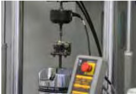
FIGURA 8 – Máquina de ensaios mecânicos MTS - *Material Test System*.
