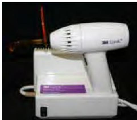
FIGURA 6 – Fotopolimerizador de luz halógena/XL 3000®.
