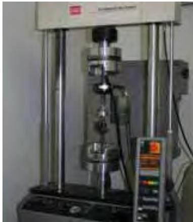
FIGURA 12 – Máquina de ensaios mecânicos MTS - *Material Test System*.
