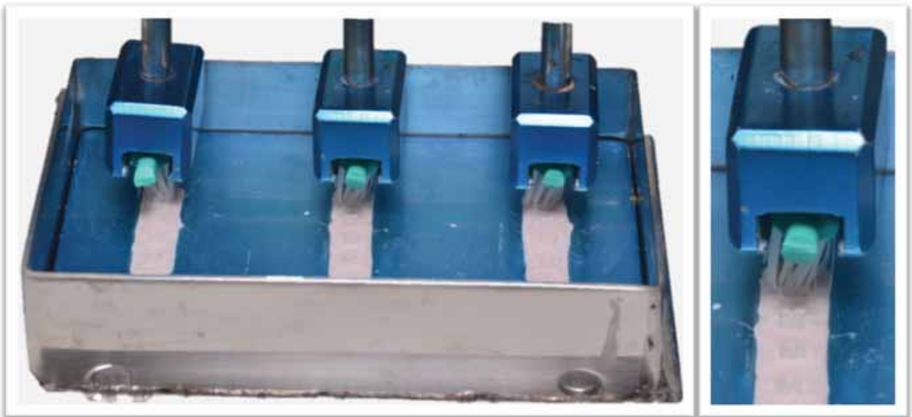
FIGURA 4 - VISÃO APROXIMADA DO POSICIONAMENTO DOS BRAQUETES NA MATRIZ DE SILICONA INSERIDOS NA MÁQUINA DE ESCOVAÇÃO MAVTEC® .
