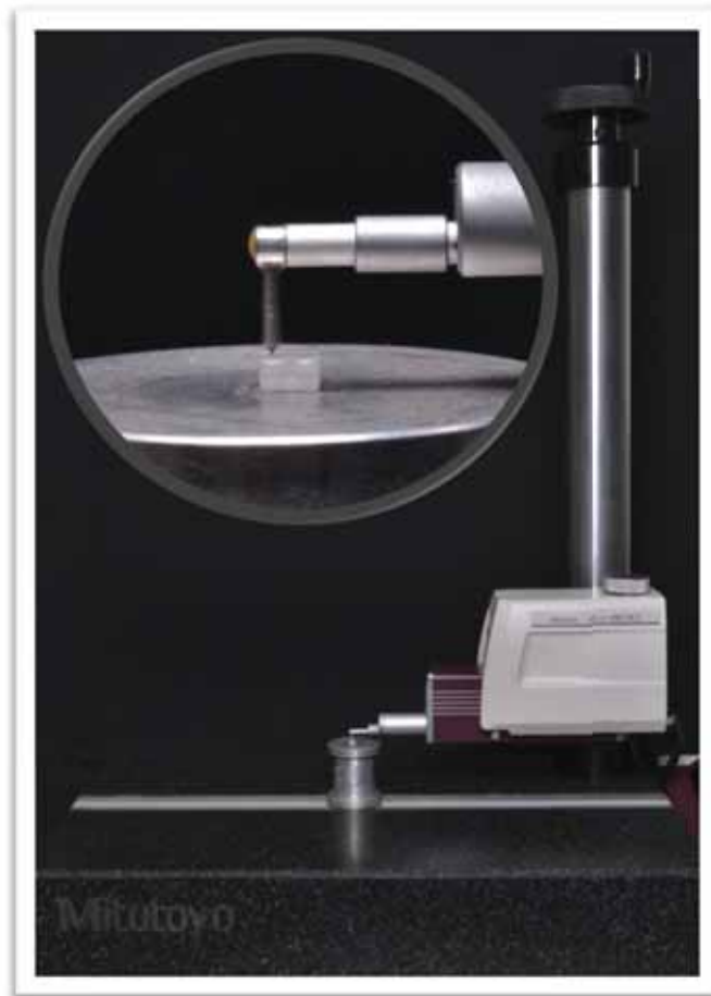
FIGURA 6 - RUGOSÍMETRO UTILIZADO PARA MENSURAR A RUGOSIDADE SUPERFICIAL DOS BRAQUETES CERÂMICOS.
