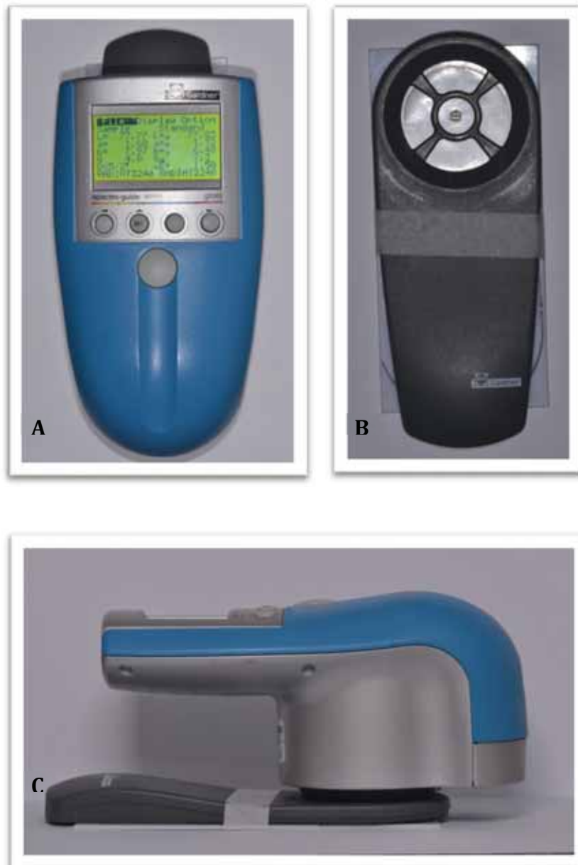
FIGURA 5 - VISTA FRONTAL DO ESPECTROFOTÔMETRO DE REFLECTÂNCIA (ESPECTRO GUIDE) (A), DO POSICIONADOR COM O BRAQUETE INSERIDO (B) E VISTA LATERAL DE TODO O CONJUNTO POSICIONADO PARA MENSURAR A COR (C).
