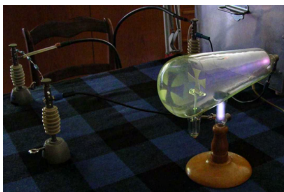
Figura 9 – Tubo de Crookes ou CRT (1879) e Sir William Crookes (1832-1919).
