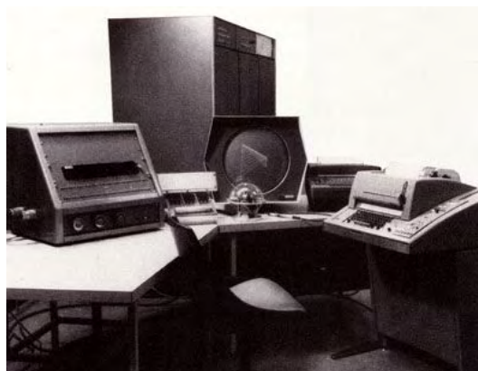
Figura 13 - DEC PDP-1: Primeiro computador comercial com monitor e teclado (1960).
