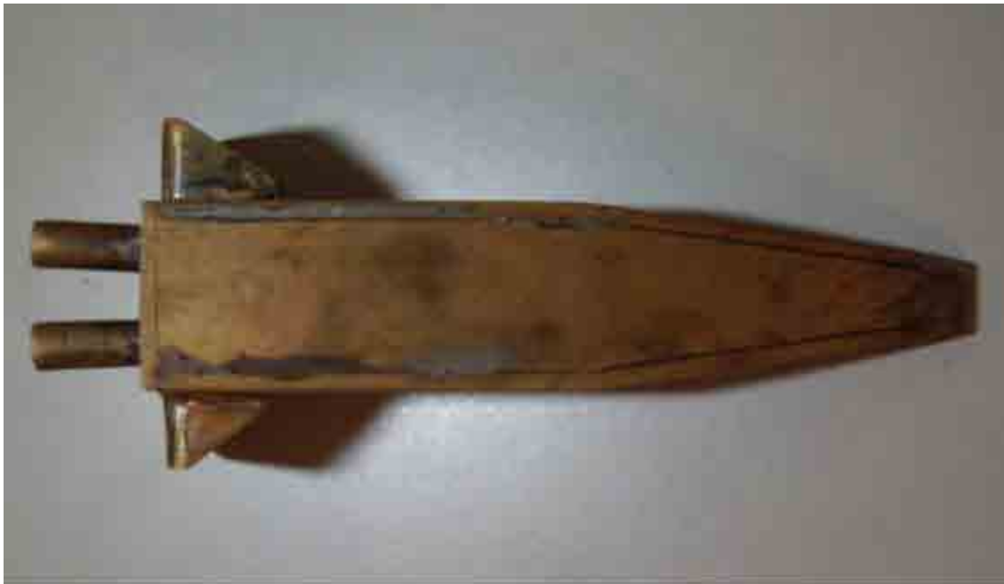
Figura 10 – Bocal confeccionado para aspersão de Mínima Quantidade de Lubrificante.
