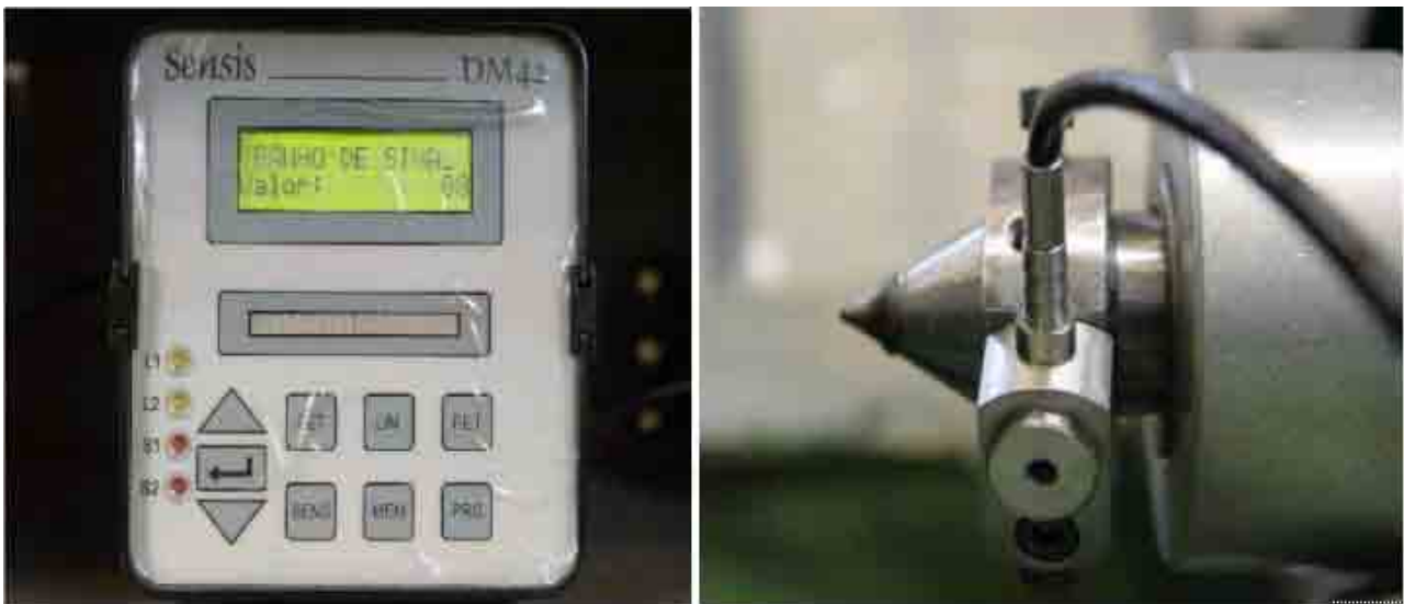
Figura 19 – Equipamento de Emissão Acústica e sensor de EA acoplado na contra-ponta
