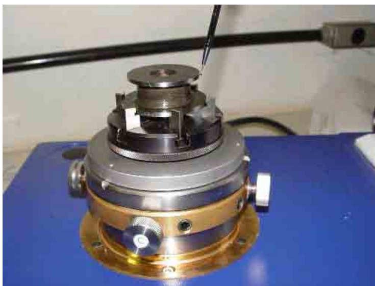
Figura 25 – Medição dos desvios de circularidade do corpo de prova
