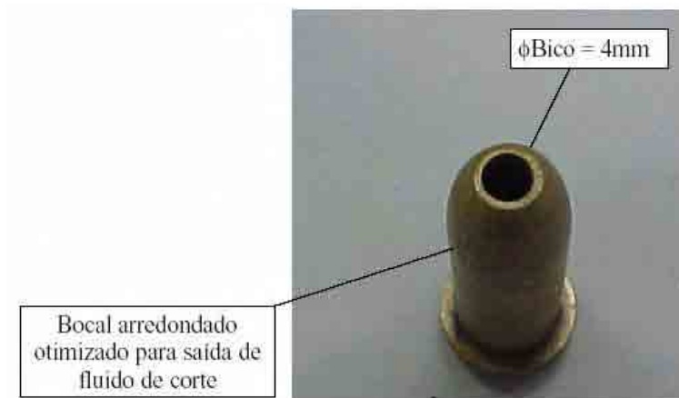
Figura 13 – Bocal utilizado no método de lubri-refrigeração Webster.
