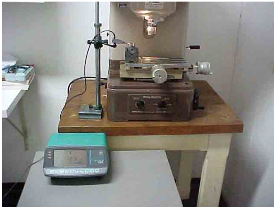
Figura 27 – Aparelho TESA para medição do desgaste do tarugo
