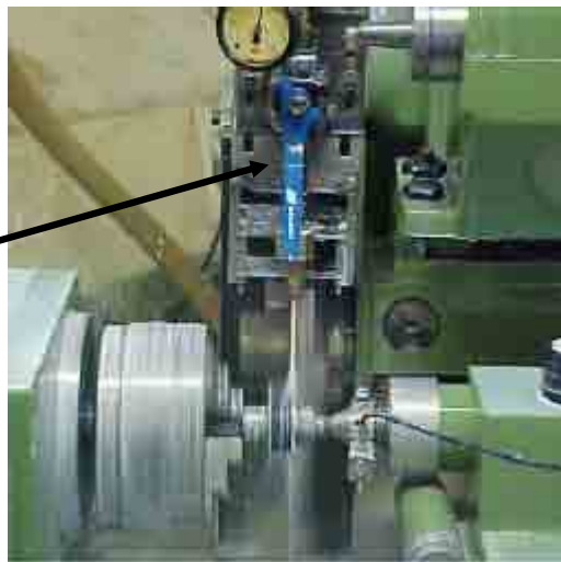
Figura 14 – Visualização do processo de retificação utilizando-se um bocal otimizado
