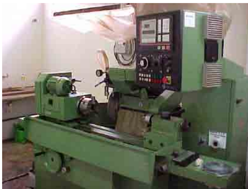
Figura 17 – Retificadora cilíndrica SULMECÂNICA com CNC (Comando Numérico Computadorizado).
