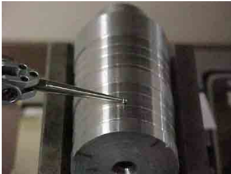
Figura 28 – Apalpador percorrendo região de desnível
