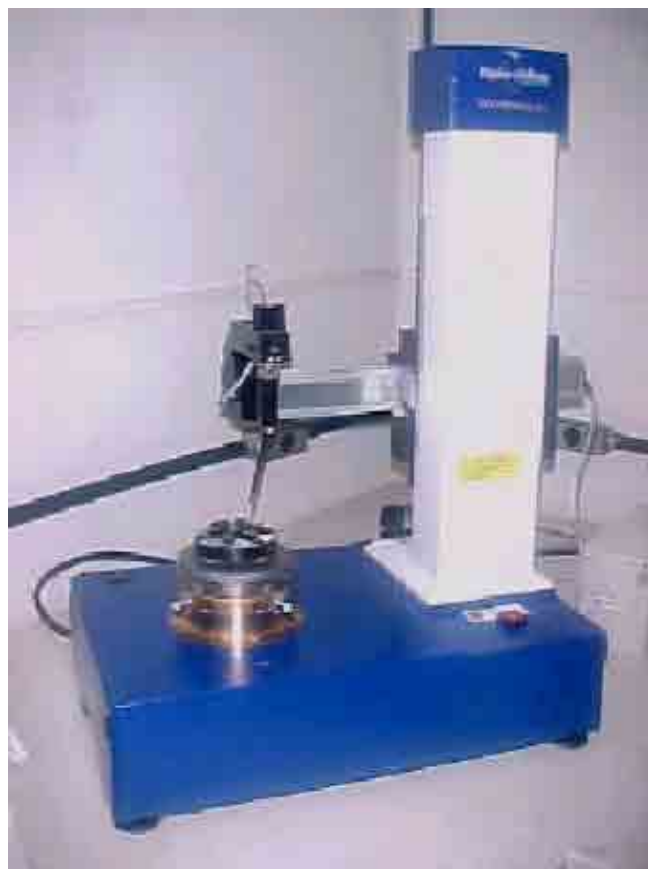
Figura 24 – Medidor de desvios de circularidade
