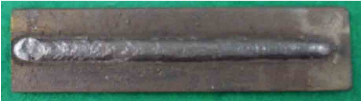
Figura 13 – Solda realizada utilizando o grupo 2 – A_p = 350A ; A_b = 40A ; F = 100 Hz e T_p = 2,00 ms.
