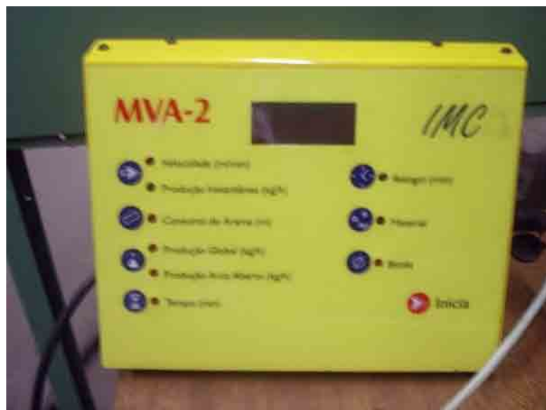
Figura 10 – Equipamento de medição e monitoração do processo de soldagem.
