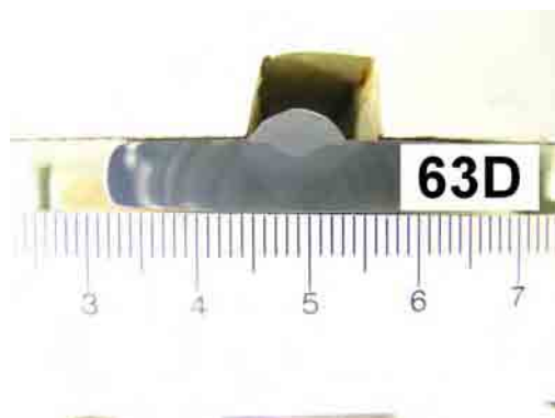
Figura 59 – Fotomicrografia do grupo 14 - A_p = 350A ; A_b = 30A ; F = 150 Hz e T_p = 2,20 ms.
