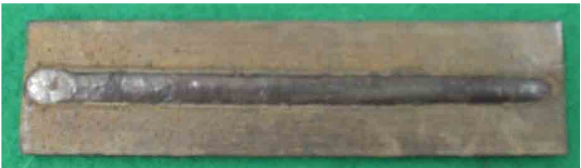
Figura 12 – Solda realizada utilizando o grupo 1 – A_p = 350A ; A_b = 30A ; F = 100 \text{ Hz} e T_p = 2,00 \text{ ms} .
