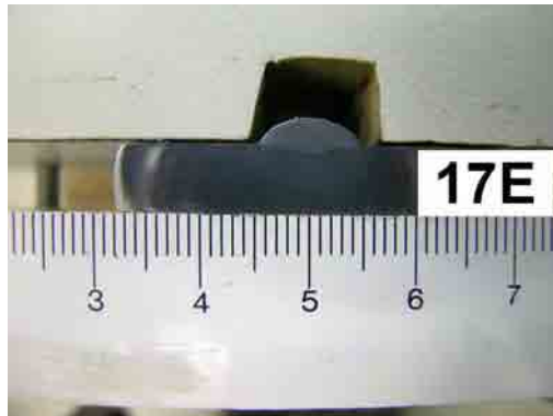
Figura 48 – Fotomicrografia do grupo 3 - A_p = 350A ; A_b = 50A ; F = 100 Hz e T_p = 2,00 ms.
