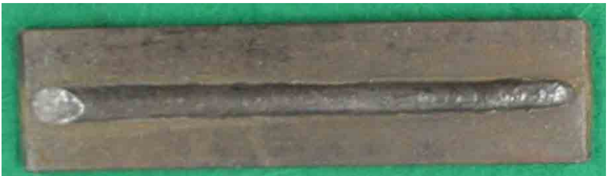
Figura 18 – Solda realizada utilizando o grupo 7 – A_p = 400A ; A_b = 30A ; F = 100 Hz e T_p = 2,00 ms.
