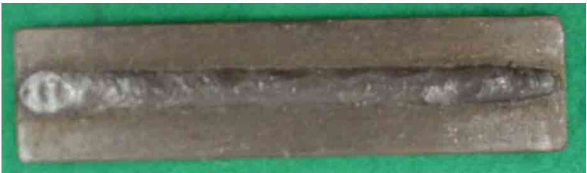
Figura 14 – Solda realizada utilizando o grupo 3 – A_p = 350A ; A_b = 50A ; F = 100 Hz e T_p = 2,00 ms.
