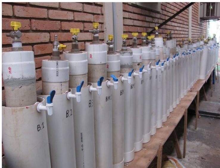
Figura 8 – Vista parcial dos digestores batelada.
