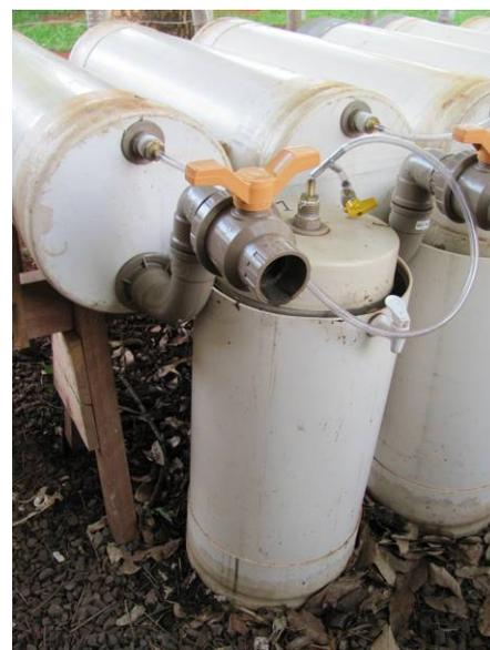
Figura 10 - Detalhe do cano de saída e do gasômetro.
