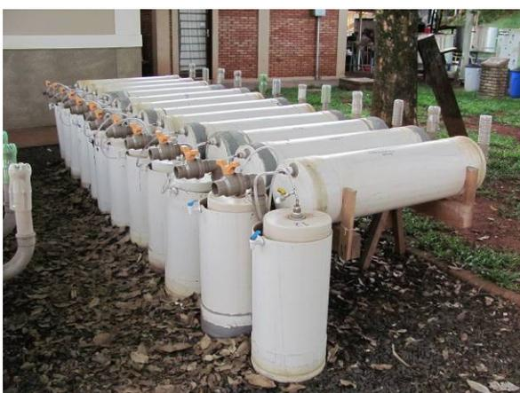
Figura 9 – Vista parcial dos digestores contínuos.
