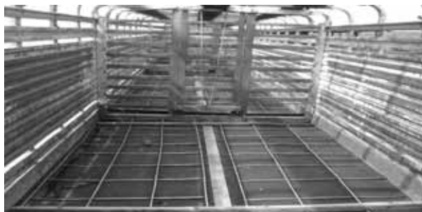
Figura 2. Assoalho de um compartimento de carga com borrachão e grade.
