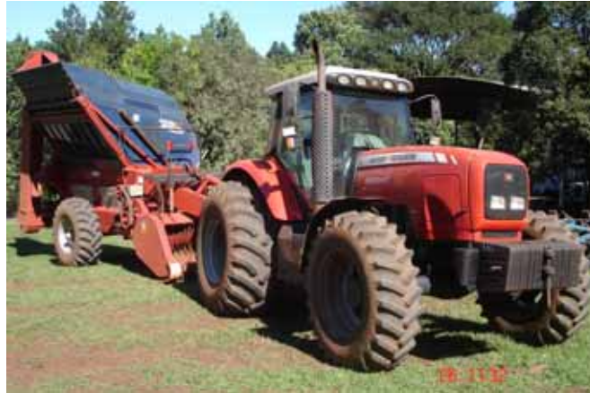
Figura 4. Conjunto trator x recolhedora utilizado no recolhimento de amendoim.
