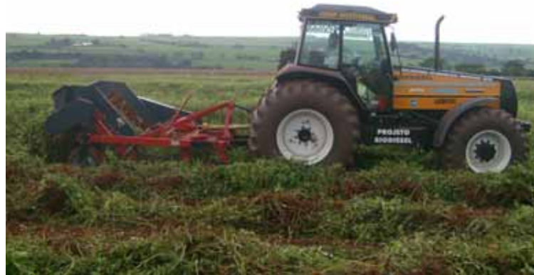
Figura 3. Conjunto trator x arrancador-invertedor utilizado no arranquio.
