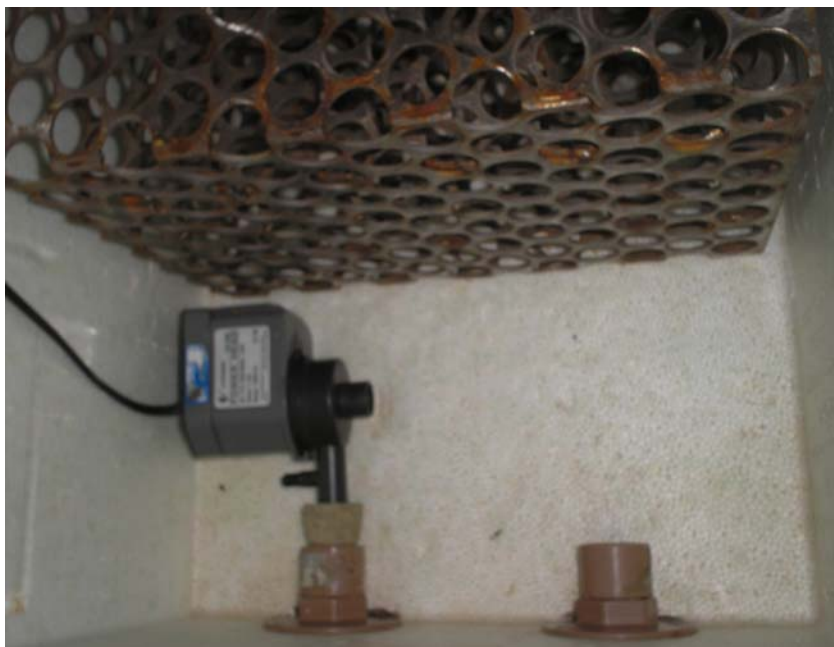
Figura 2. Instalação da bomba submersa no interior e inferior a caixa de isopor.
