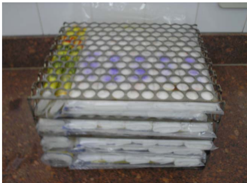
Figura 6. Armação de aço inox com quatro repartições utilizada na acomodação das embalagens seladas.
