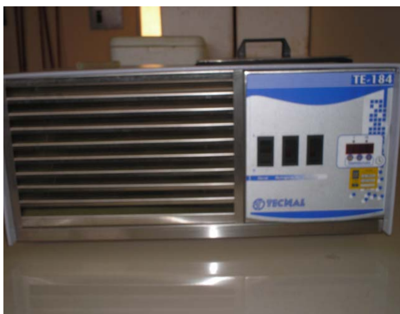
Figura 3. Banho termostático Tecnal, modelo Te-184.
