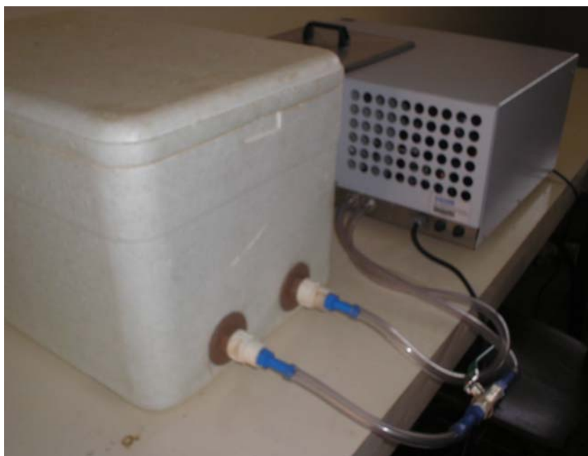
Figura 4. Conexão da caixa de isopor com banho termostatizado Tecnal, modelo Te-184 por meio de mangueiras de silicone.
