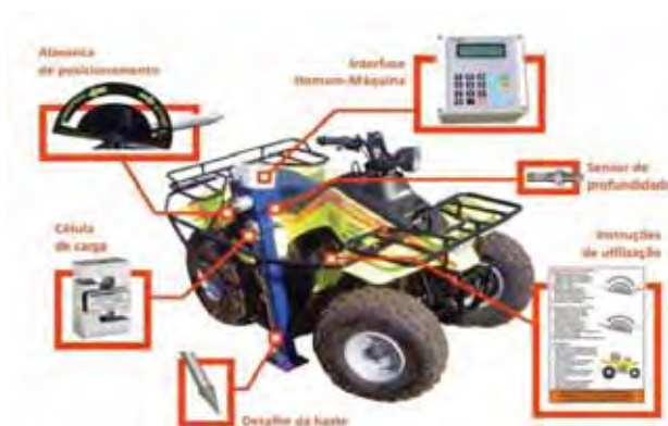
Figura 8. Quadriciclo com penetrômetro utilizados para amostragem do IC.
