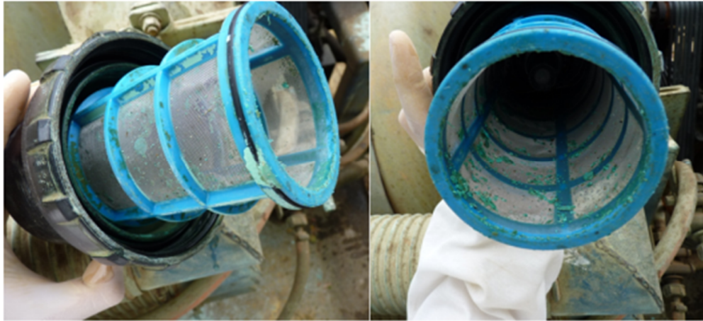
Figura 6: Filtros de sucção em bom estado. Petrolina – PE, 2011.
