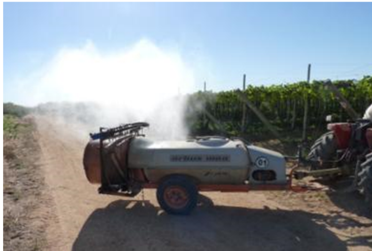
Figura 3: Perdas por ausência de antigotejadores. Petrolina - PE, 2011
