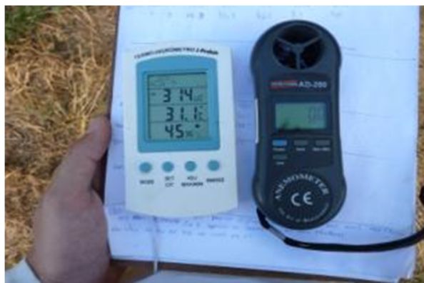
Figura 2: Medidor de temperatura e umidade relativa (termo-higrômetro) e velocidade do vento (anemômetro). Petrolina-PE, 2011.
