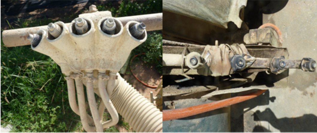
Figura 2: Ausência de antigotejadores nos pulverizadores. Petrolina – PE, 2011.
