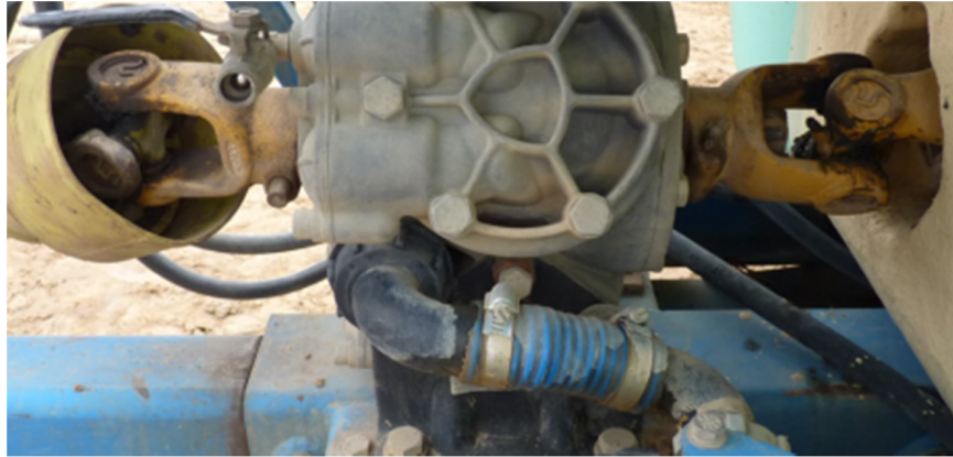
Figura 4: Vazamento na mangueira de recalque. Petrolina – PE, 2011.
