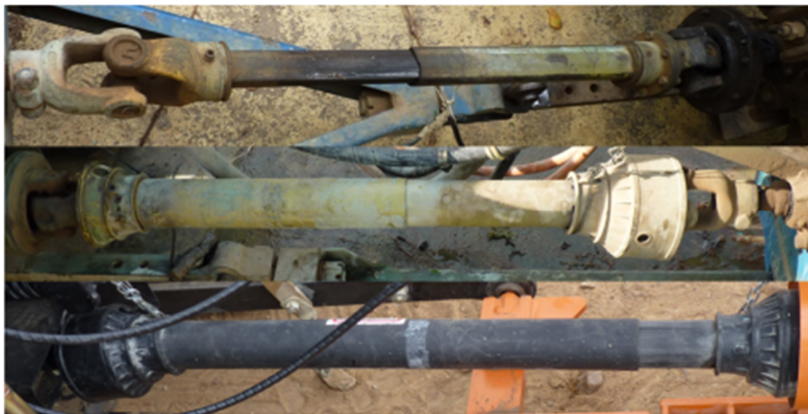
Figura 9: Proteção das partes móveis (Cardam). Petrolina – PE, 2011.
