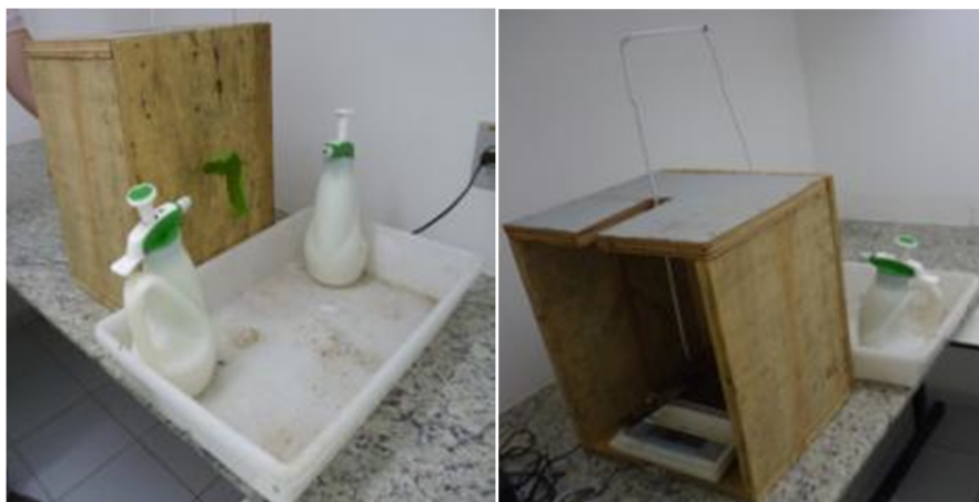
Figura 2: Equipamento de avaliação de retenção foliar das formulações de fungicidas.
