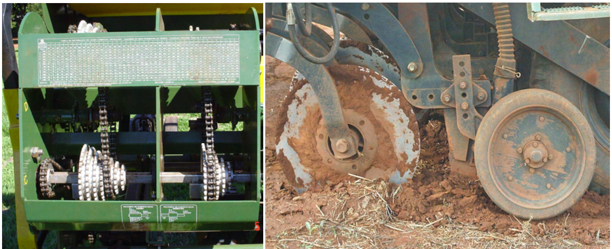
Figura 2. Caixa de engrenagens para mudança da densidade (esquerda) e roda de controle de profundidade (direita).
