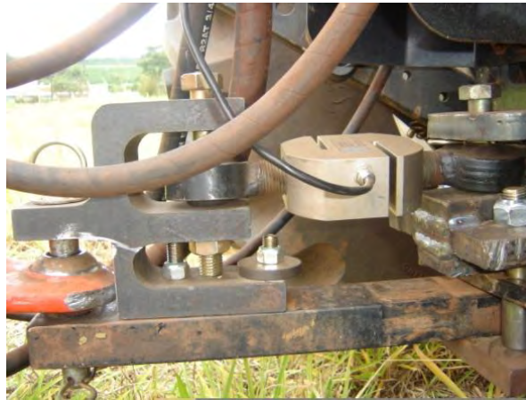
Figura 3. Célula de carga com capacidade para 100 kN utilizada para determinação da força de tração na barra.
