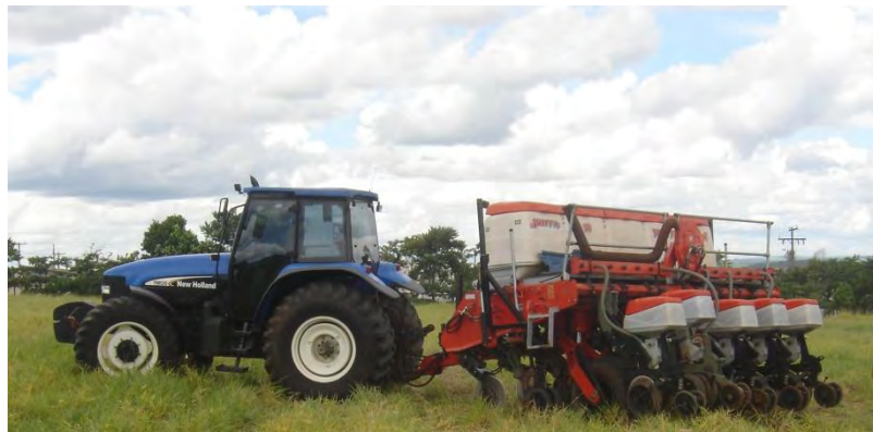
Figura 2. Conjunto trator-semeadora-adubadora utilizado no experimento.
